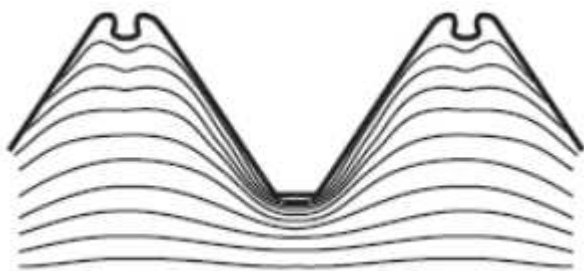
Obr. 2: Tvářený - válcovaný závit
