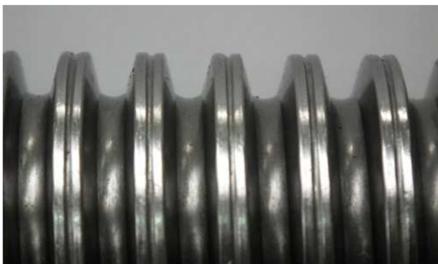
Obr. 5: Tvářený - válcovaný závit s drážkou na povrchu
