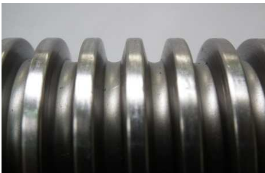
Obr. 4: Tvářený - válcovaný závit hladký
